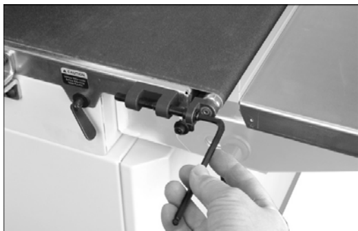
Рис. 7-3: регулировка натяжения ленты
