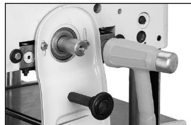
Рис. 26 Отсоединение ножевого вала от бабки станка
