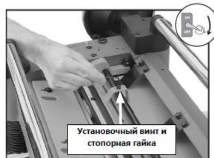
Рис. 25 Регулировка высоты стружколомателя
