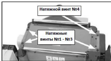
Рис. 26 Виты для регулировки натяжения пружин роликов
