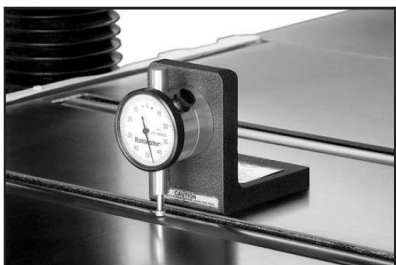
Рис. 22 Инструмент для точной регулировки станка Rotacator
