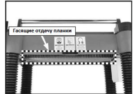
Рис. 29 Гасящие отдачу планки (гребенка)
