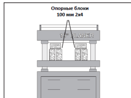
Рис. 24 Расположение опорных блоков
