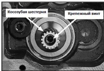
Рис. 27 Косозубая шестерня и крепежный винт
