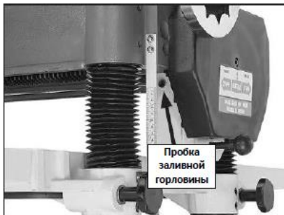
Рис. 8 Пробка заливной горловины коробки скоростей
