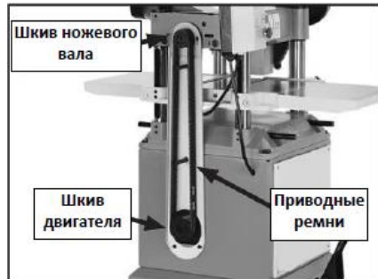
Рис. 19. Ограждение ремней снято
