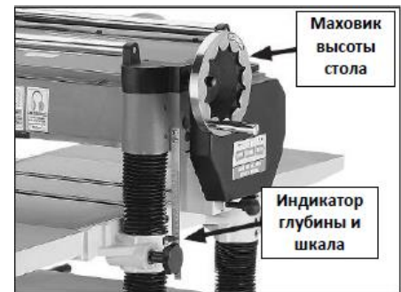
Рис. 12 Индикатор глубины резания и шкала
